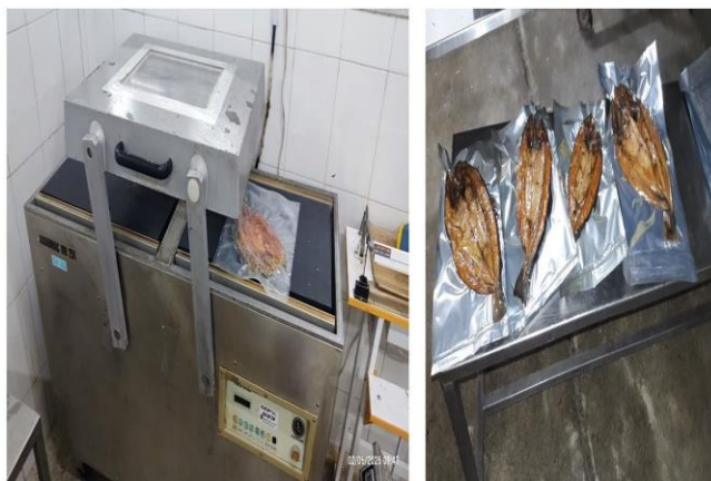
شکل ۵. بسته بندی محصولات دودی شده به روش وکیوم
