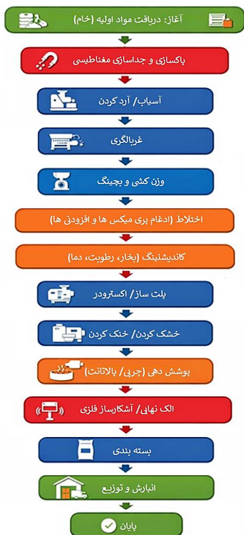
شکل ۱. فلوجارت جریان کلی تولید خوراک خشک آبزیان (برگرفته از Hasting & Higgs, 1980)
